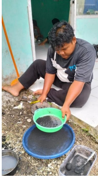
Gambar 7. Penyaringan arang pelepah sawit
