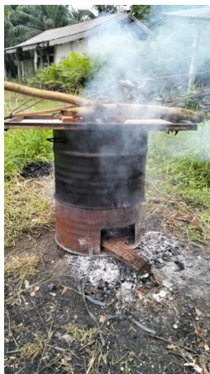
Gambar 5. Proses karbonisasi pelepah kelapa sawit
