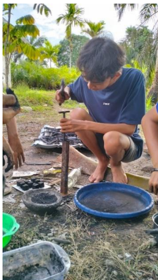
Gambar 9. Pencetakan briket pelepah sawit
